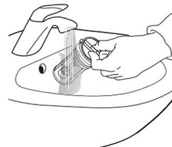
11. Inserte el filtro de agua y vuelva a instalar el zócalo: Vuelva a insertar el filtro de agua girándolo en el sentido de las agujas del reloj. Asegúrese de que lo ha girado todo lo posible el agarre del filtro debe estar en posición vertical. Para probar la estanqueidad del filtro de agua, puede verter alrededor de un litro de agua en el dispensador de detergente. Y reinstalar el zócalo a continuación.
