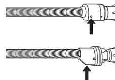
Para las mangueras de desagüe: compruebe la ventanilla de inspección de la válvula de seguridad (vea la flecha). Si es de color rojo, significa que la función desagüe estaba activada, y deberá sustituir la manguera por una nueva. Para desenroscar la manguera, pulse el botón de liberación (si hay uno) mientras la desenrosca.
