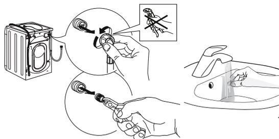
4. Vuelva a introducir el filtro de malla. Vuelva a conectar la manguera de entrada al grifo y a la máquina. No utilice ninguna herramienta para conectar la manguera de entrada. Abra el grifo y compruebe que las conexiones estén bien ajustadas.
