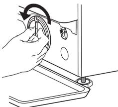
9. Retire el filtro: Ponga un paño de algodón debajo del filtro de agua para absorber la pequeña cantidad de agua que quede. Retire el filtro de agua girándolo en el sentido de las agujas del reloj.
