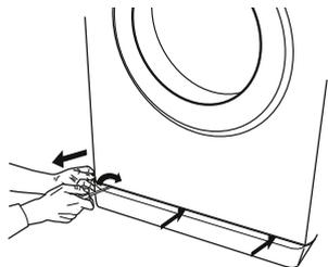
7. Recipiente para el agua del vaciado: Ponga un recipiente bajo y ancho debajo del filtro de agua para recoger el agua residual.
