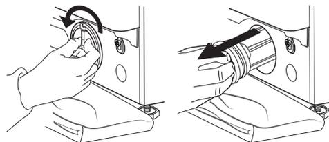
10. Limpie el filtro de agua: retire los residuos del filtro y lávelo con agua corriente.
