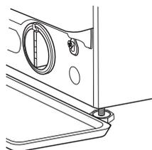
8. Drene el agua: Gire el filtro lentamente en el sentido contrario a las agujas del reloj hasta que haya salido toda el agua. Deje salir el agua sin retirar el filtro. Cuando el recipiente esté lleno, cierre el filtro de agua girándolo en el sentido de las agujas del reloj. Vacíe el recipiente. Repita el procedimiento hasta que haya salido toda el agua.
