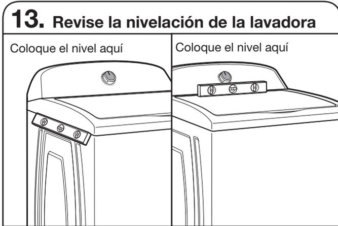
Con la lavadora en su ubicación final, coloque un nivel en los bordes superiores de la lavadora. Use la hendidura lateral como una guía para revisar la nivelación de los lados. Revise la nivelación del frente usando la tapa, como se muestra. Balancee la lavadora hacia delante y hacia atrás para asegurarse de que las 4 patas hagan contacto firme con el piso. Si la lavadora está nivelada, saltee al paso 14.
